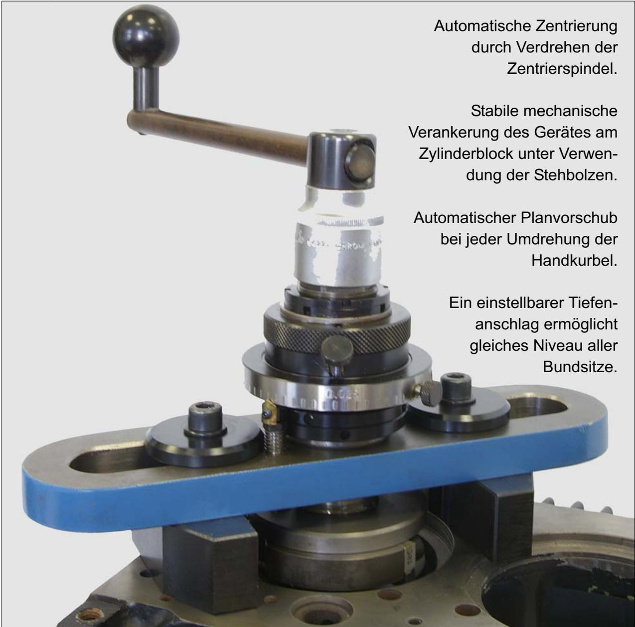
Automatische Zentrierung durch Verdrehen der Zentrierspindel.
