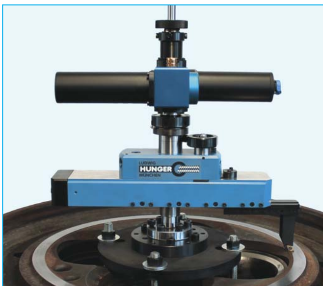
Plandrehen von Dichtflächen
